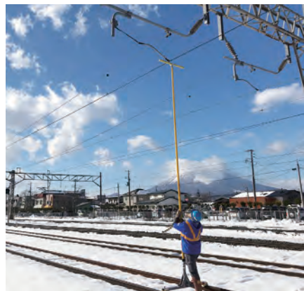
トリ線の高さや偏位が適正であるか、架線測定器を使用して測定しています。
